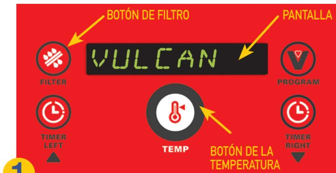
**1** Cerciórese que el botón de encendido esté en la posición "ENCENDIDO". La freidora debe estar encendida para operar el motor/bomba. La temperatura de la freidora debe estar entre 300-350 grados Fahrenheit. **RECOMENDACIÓN: AGREGAR EL MEDIO DE TRATAMIENTO DE ACEITE**
