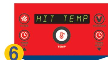
**6** Una vez que se verifica el nivel del aceite, presione el botón de la temperatura. Los quemadores volverán a encenderse automáticamente y la freidora volverá a calentarse. La pantalla muestra **AUMENTAR LA TEMPERATURA.**
