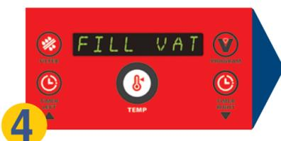
**4** Cuando termine la filtración, cierre la válvula roja de drenaje girando la manilla roja de drenaje. La pantalla muestra **LLENAR TANQUE.**
