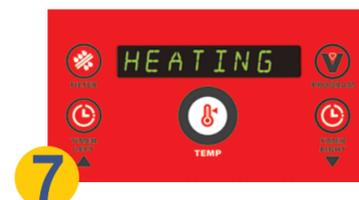
**7** Después de presionar el botón de la temperatura, la freidora vuelve a calentarse. La pantalla muestra **CALENTANDO.**
